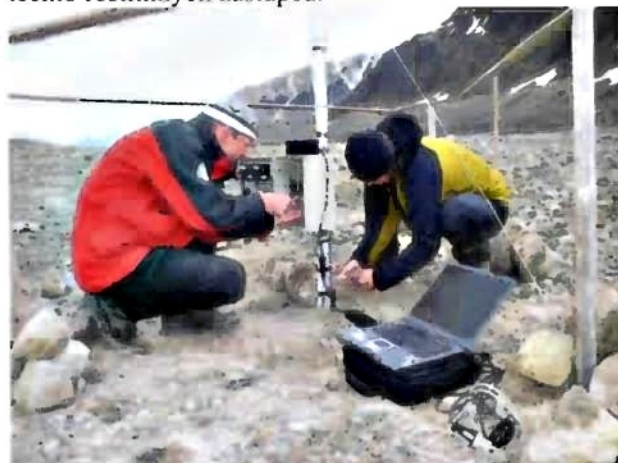
Instalace automatické mikroklimatické stanice, kde se měří hlavní meteorologické parametry (teplota vzduchu a půdy v různých hloubkách, záření dopadající a odražené, vlhkost vzduchu a obsah vody v půdě a další)
